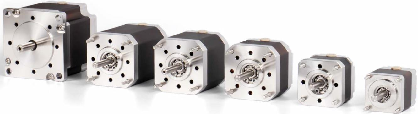
英国AML的D系列超高真空步进电机是步距角为 $1.8^\circ$ 的两相混合式步进电机，可提供28至57系列的标准规格，适用于 $1 \times 10^{-10}$  mbar的超高真空环境，工作温度 $-65^\circ\text{C}$ 至 $+190^\circ\text{C}$ 之间，可扩展低温版本( $-196^\circ\text{C}$ )、耐辐照版本(总吸收剂量 $1 \times 10^6$  Gy)，并且可以接受定制。
