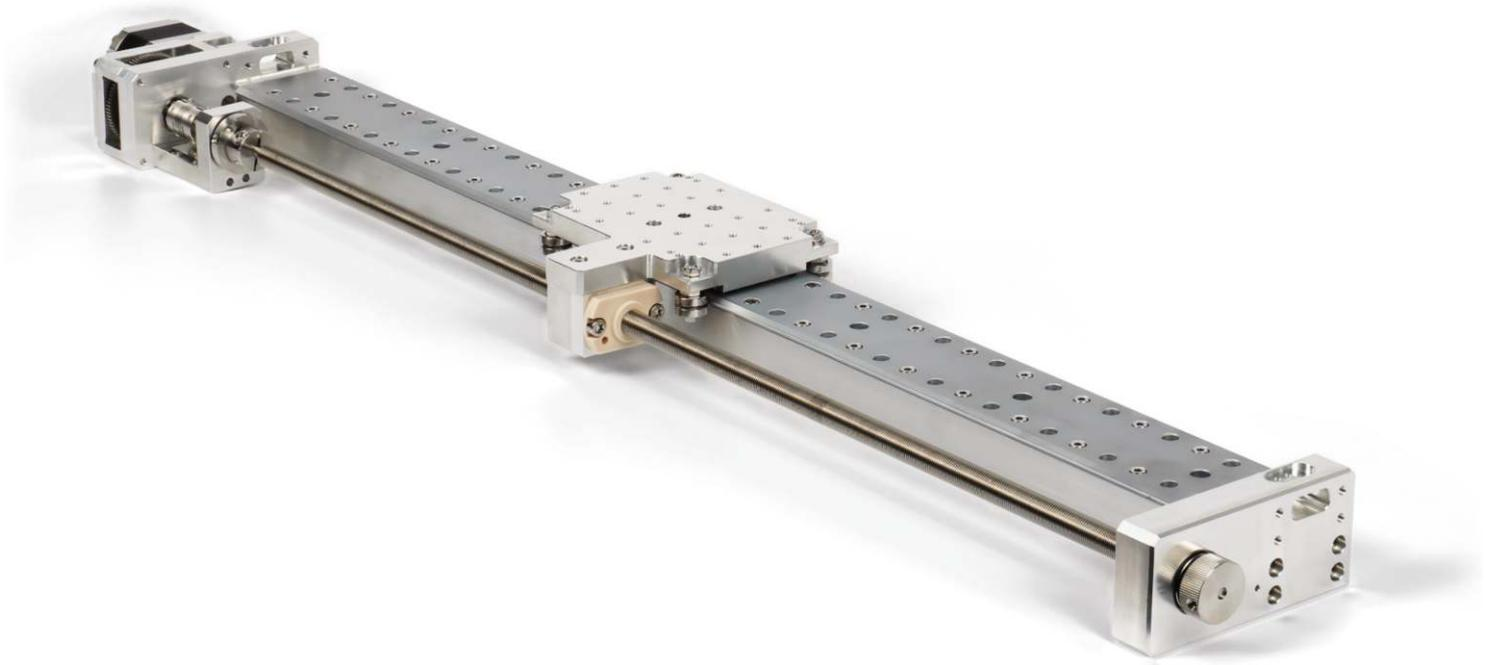
超长行程超高真空运动平台的有效行程可达1000mm，承载可达40kg。它们采用宽间距的“V”型滚子导轨，非常符合长行程但扭转载荷很小的应用。
